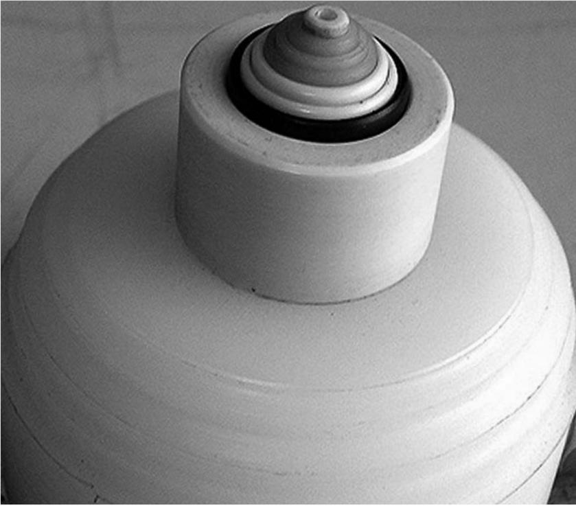
*Un display aptico di tipo CASR per un singolo polpastrello.*
