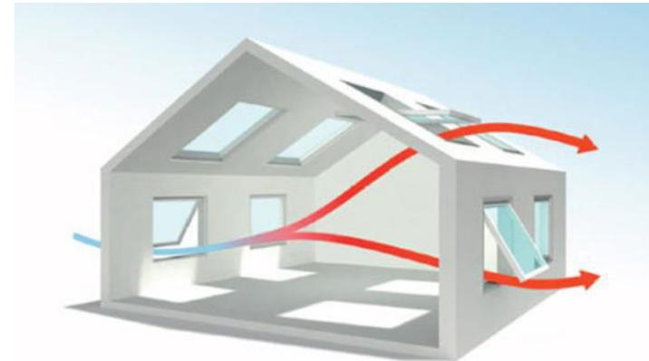
Nel dimensionare e posizionare le aperture o gli impianti di ventilazione è necessario tenere conto sia delle quantità che della densità dei gas o dei vapori infiammabili che possono essere presenti.
