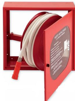
I NASPI sono costituiti da una tubazione semirigida avvolta su una bobina già collegata sia alla rete idrica che alla lancia erogatrice. Si trovano all'interno di una cassetta antincendio, incassata nel muro o appesa alla parete, con anta apribile almeno a 170° e bobina che permette di srotolare la tubazione orientabile.
