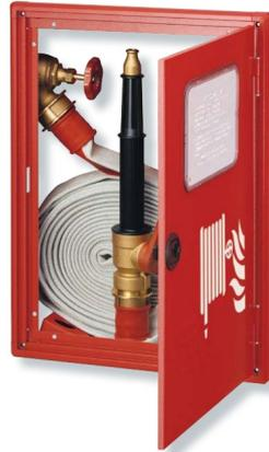
Gli IDRANTI sono costituiti da una tubazione che si può appiattare, di diversi diametri, una lancia per l'erogazione dell'acqua con possibilità di frazionare o intercettare il getto e una cassetta ove riporre l'attrezzatura quando non viene utilizzata.
