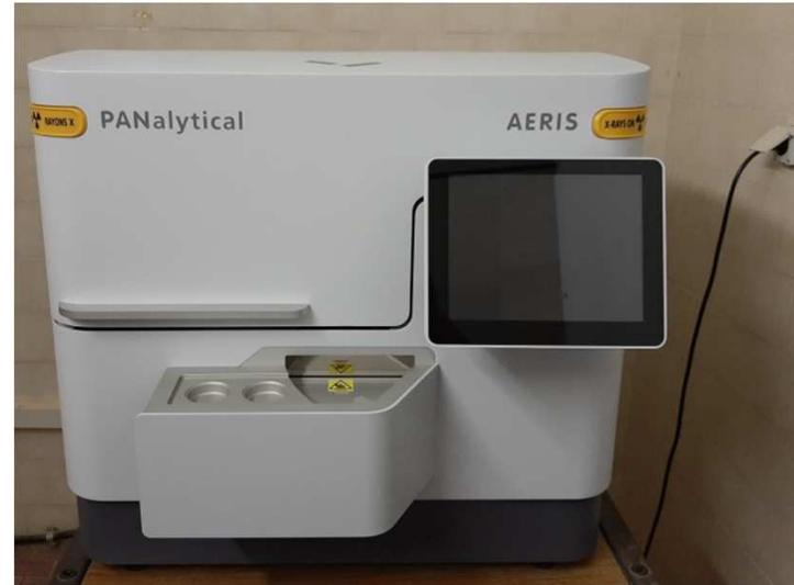
Esempi: diffrattometri Bruker mod. D2 PHASER e Malvern Panalytical mod. AERIS (per entrambe la tensione max. è 30 kV)
