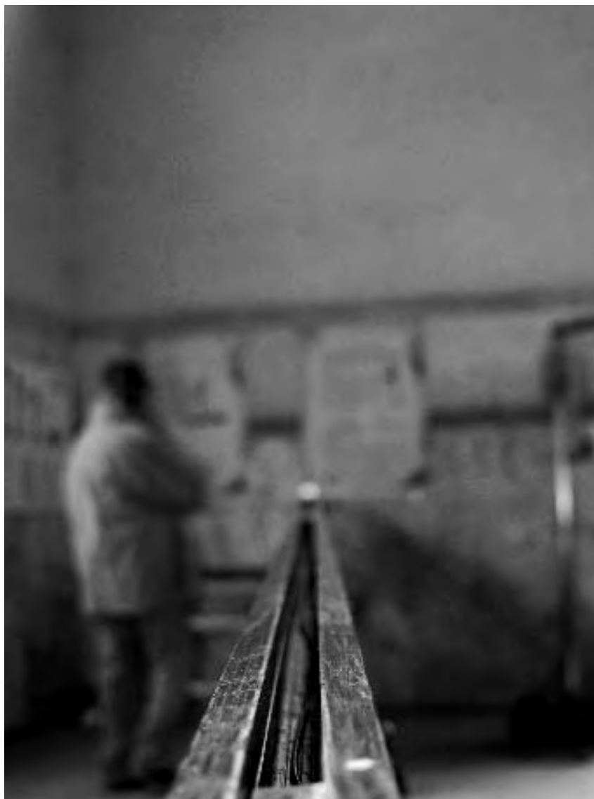
Il piano inclinato per la verifica della legge dei numeri dispari.
