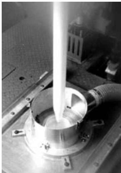
Depurazione e filatura della fibra a partire da una barra di silicio nei laboratori della Corning Glass Work.
