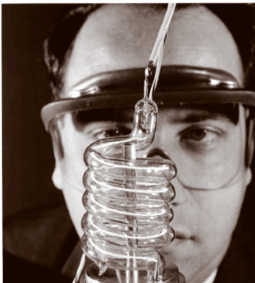
T. H. Maiman e il suo prototipo di laser a rubino (1960). I laser a rubino avranno vasta applicazione in diversi settori: chirurgia, lavorazioni meccaniche, localizzazione di bersagli in campo militare, scanner, lettori di codici a barre e di compact disc.
