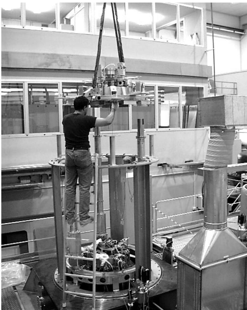
*L'esperimento deve essere isolato da qualsiasi interferenza sismica. Per questo sono stati messi a punto dei "super attenuatori" ove collocare gli specchi.*
