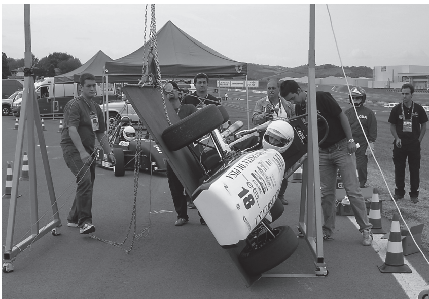
La ET1 viene sottoposta al Tilt Test: la macchina viene inclinata fino a 60 gradi per verificare che non perda liquidi e che non si ribalti.
